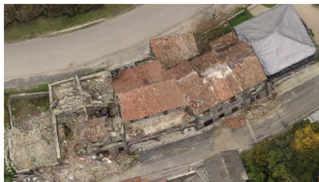
Figura 2. Modello 3D ottimizzato e con textures di elevata qualità generato da datasets integrati di immagini nadirali e oblique.
