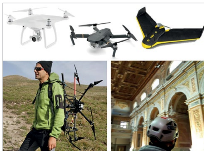
Figura 3. Alcuni modelli rappresentativi di droni impiegati nelle applicazioni svolte nei diversi siti dell'area del terremoto del Centro Italia. Sopra: i droni multi-cotteri COTs della DJI insieme al drone ad ala fissa eBee della SenseFly. Sotto, a sinistra: l'escottero professionale Ubik DIATI MK01 sulle spalle di Paolo Maschio, primo pilota del Laboratorio di Geomatica del DIATI. A destra: volo d'ispezione e ripresa video all'interno della chiesa di San Nicola di Tolentino del drone DJI Mavic, pilotato da Lorenzo Teppati del Lab di Geomatica del DAD.
