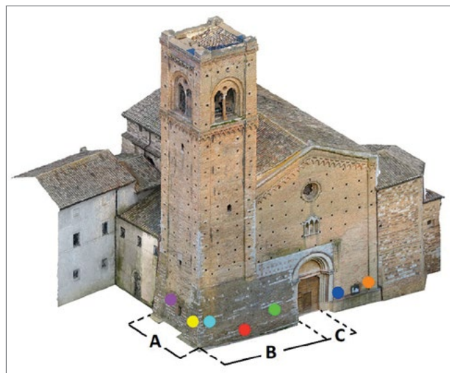
Figura 2. Modello fotogrammetrico 3D, sul quale sono evidenziate la distribuzione spaziale delle distanze utilizzate per scalare il modello fotogrammetrico (a, b e c) e dei punti di verifica utilizzati per l'analisi dei residui dopo l'allineamento della nuvola fotogrammetrica con la nuvola TLS.
