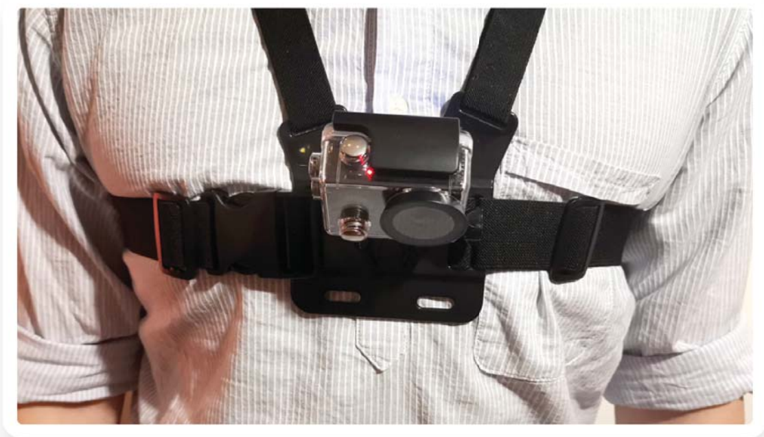
fig. 3.18 Il setup dell'action cam per la rilevazione dei movimenti. La posizione riprende quella ipotizzata per il wearable, ma l'ampiezza della visuale non consente la rilevazione corretta dei movimenti.
