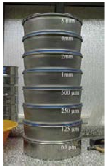
figg. 48, 49 e 50 – Disgregazione e riduzione del campione. Serie di setacci di prova con dimensione delle aperture.
