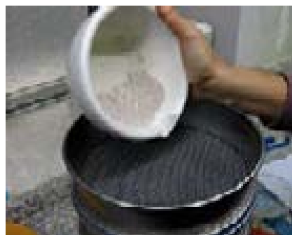
figg. 48, 49 e 50 – Disgregazione e riduzione del campione. Serie di setacci di prova con dimensione delle aperture.
