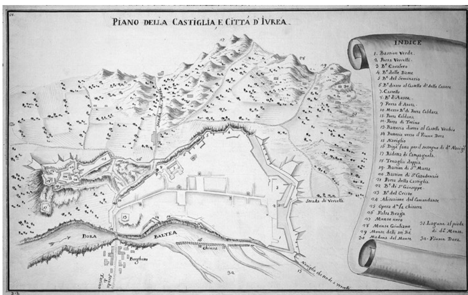
Fig. 3. S.a., Piano della Castiglia e Città d'Ivrea , s.d. (ASTo, Corte, Carte topografiche e disegni, Carte topografiche segrete , Ivrea, 27 A III rosso). L'assetto delle fortificazioni di Ivrea a metà del Settecento: da notare la scomparsa della Cittadella; sono inoltre leggibili le variazioni del tessuto urbano della prima metà del secolo, con l'apertura della piazza Palazzo di Città.
