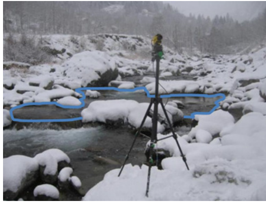
Figura 2.14 – Esempi di identificazione e delimitazione del contorno di due unità morfologiche (di tipo pool a sinistra e glide a destra) rispettivamente in un torrente montano (Torrente Savara, Aosta) e in un corso d'acqua di pianura (Fiume Nestos, Grecia), attraverso l'utilizzo di un telemetro laser in comunicazione via Bluetooth con un computer palmare da campo.
