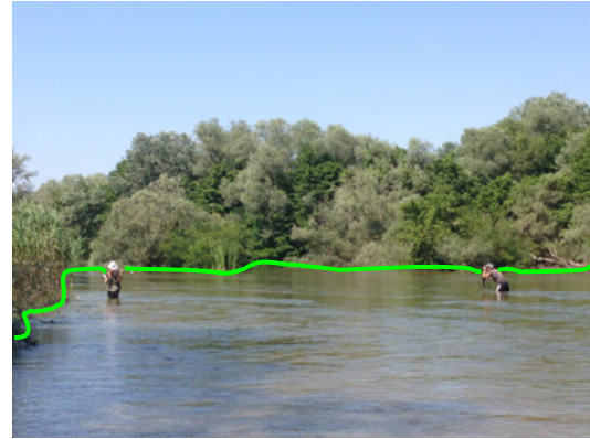
Figura 2.14 – Esempi di identificazione e delimitazione del contorno di due unità morfologiche (di tipo pool a sinistra e glide a destra) rispettivamente in un torrente montano (Torrente Savara, Aosta) e in un corso d'acqua di pianura (Fiume Nestos, Grecia), attraverso l'utilizzo di un telemetro laser in comunicazione via Bluetooth con un computer palmare da campo.
