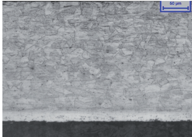
Figura 2: Micrografia ottica della sezione trasversale dell'acciaio AISI 204Cu, evidenziante lo strato superficiale indurito. Attacco gliceregia
