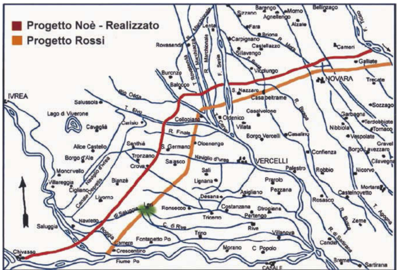
Il tracciato del canale secondo il progetto di Francesco Rossi e secondo il progetto di Carlo Noè, poi realizzato.
