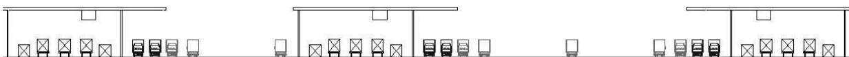
Fig. 2 - Sezione del terminale: le due gru a destra hanno in comune la corsia di entrata degli autocarri.
