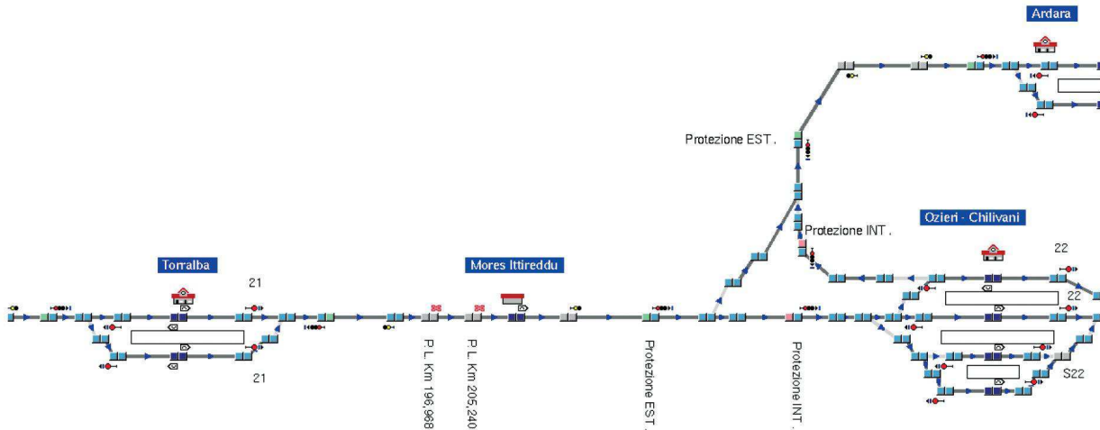
Fig. 4 - La sezione critica della linea simulata con il software Open Track. Fig. 4 - The critical section of the line as simulated by the OpenTrack software.
