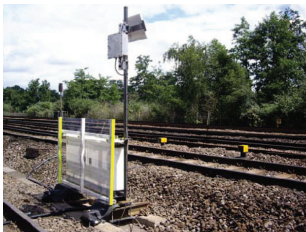
Fig. 6 - Sistema RailBAM per il monitoraggio acustico dei cuscinetti. RailBAM system for the acoustic monitoring of the bearings.
