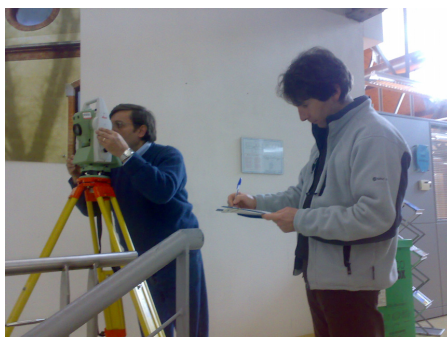
Figura 2 – Rilievo topografico dei poligoni.
