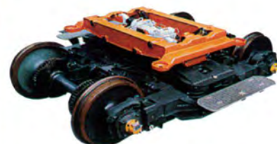
Fig. 2 – Treno di prova SBB (1975) e carrello con assetto cassa idraulico.
