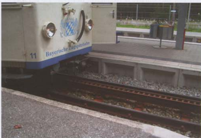
Fig. 2 - Esempio di cremagliera: applicazione in area montana (Germania).
