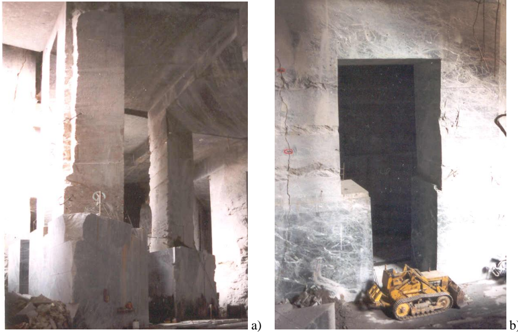
Fig.2. Esempio di vecchie coltivazioni in oficalciti di grande pregio commerciale (Verde Patrizia, valle di Gressoney –AO): nella foto a) si osserva l’irregolare distribuzione dei pilastri, talora anche molto snelli; nella foto b) è visibile una importante discontinuità subverticale che interessa completamente il pilastro posto a sinistra. La copertura è variabile da 40 a 90 m, e la cava ha disposizione parietale.
